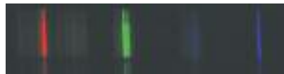
Spektrum af almindelige dagslys lamper (3-pulver lysrør) er diskontinuert. Områder, hvor Viva-Lite® har farver, er de mørke.
